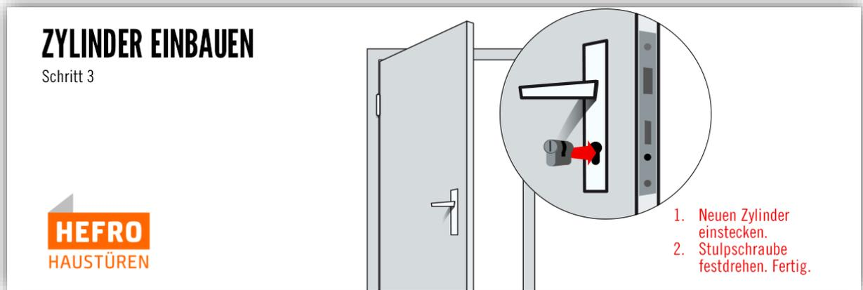
Nehmen Sie den alten Schließzylinder heraus um Abmessungen abzunehmen oder diesen einfach zu entwenden. Den neuen Zylinder nun mit der richtigen Seite einstecken, dabei den Schlüssel leicht nach links / rechts drehen, bis die Schließnase richtig sitzt. Jetzt muss der neue Zylinder nur noch mit der mitgelieferten Stulpschraube festgeschraubt werden. Fertig.
