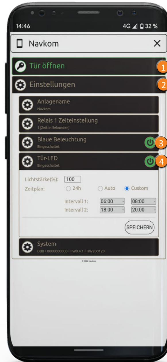
1 Durch Drücken des Tabs **Tür Öffnen - Relais** 1 wird die Tür entriegelt.
